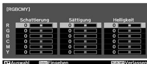
Wenn "x.v. Color" für "Farbmodus" ausgewählt ist, ist keine Einstellung möglich. Die Einstellung der Schattierung, der Sättigung und der Helligkeit für die einzelnen Farbkomponenten R (Rot), G (Grün), B (Blau), C (Zyan), M (Magenta) und Y (Gelb) kann angepasst werden.
