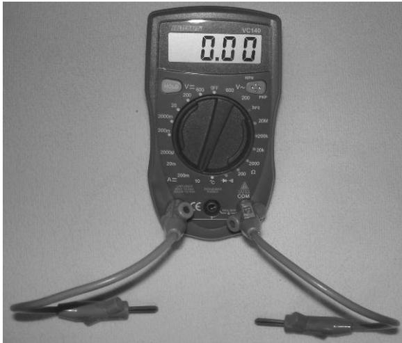
Um euer Multifunktionsmessgerät (kurz Multimeter) als Ampèremeter zu nutzen, müsst ihr die Kabel in **10Amax** und **Com** einstecken und den Messbereich auf **•10** Einstellen (reicht heute für alle Messungen aus).
