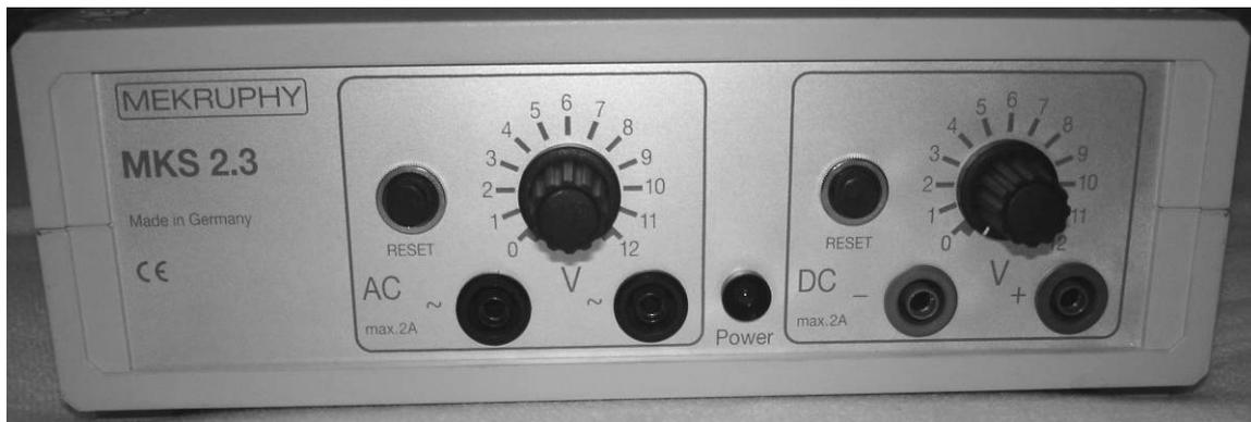
Uns interessiert im Moment nur der DC Anschluss, da wir für die Versuche eine Gleichspannung benötigen. Eure Schaltungen müsst ihr an den blauen Anschluss und an den roten Anschluss anschließen. Mit dem rechten Drehknopf könnt ihr die Spannung einstellen.
