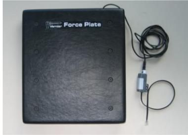
Abbildung 3.7: Eine Kraftmessplatte mit Adapter für den NXT-Stein.
