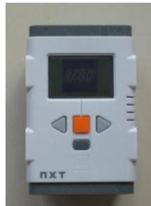
*Abbildung 3.6: Der NXT-Stein von Lego. Die Output-Anschlüsse befinden sich oben, die Input-Anschlüsse unten am Gerät.*
