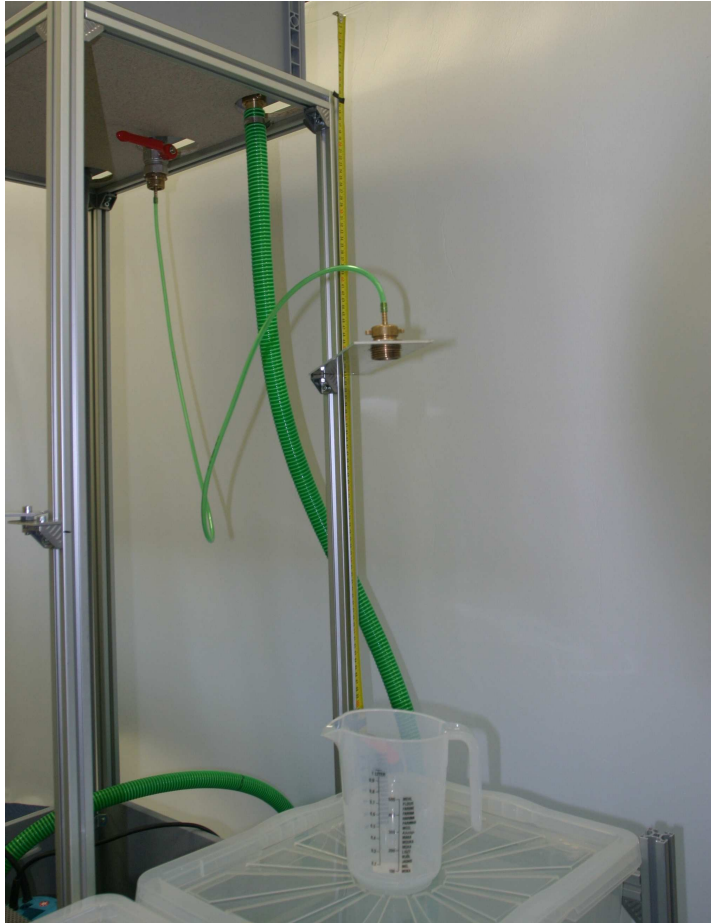
Abbildung 27: Darstellung des Aufbaus zur Überprüfung der Bernoulli-Gleichung
