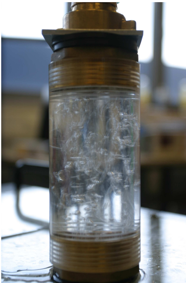
Abbildung 33: Sichtbare Turbulenzen im Plexiglasrohrstück
