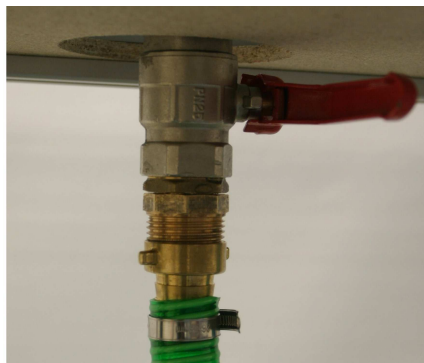
Abbildung 52: Darstellung des Anschlusses der Schlauchleitung (links) beziehungsweise der Druckrohrleitung (rechts) an den Kugelhahn
