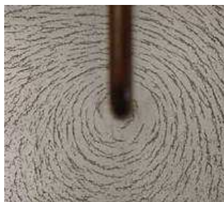
Abb. 2 : Eisenfeilspanbild eines stromdurchflossenen Leiters
