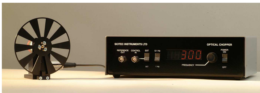
Abbildung 16: Optischer Chopper (10 Slot Scheibe) mit Kontrolleinheit der Firma Scitec Instruments (Maßstab ungefähr 1:4,5) 29
