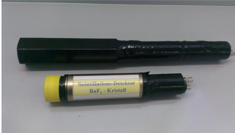
Abbildung 13: **oben:** TAPS (Two-Arm Photon-Spectrometer) BaF<sub>2</sub> Szintillator. Fortan als *TAPS Szintillator* bezeichnet.
