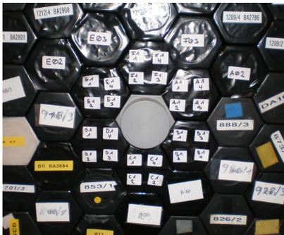
(a) Das  $PbWO_4$ -Array eingebaut in die TAPS Wand
