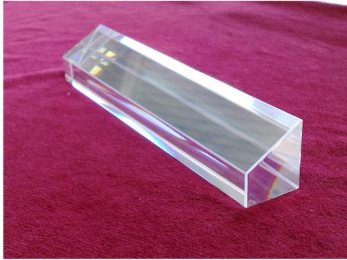
Abbildung 3.9: Bild eines verwendeten  $PbWO_4$ -Kristalls
