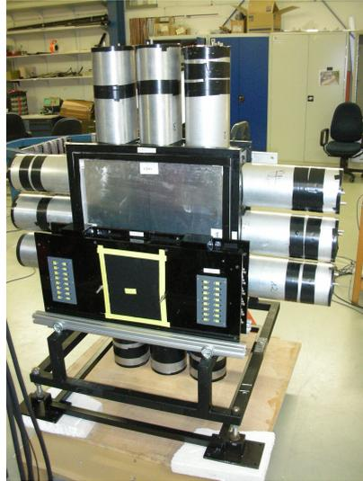
Abbildung 2.9: Čerenkov-Detektor mit Y-Hodoskop [Spr07]
