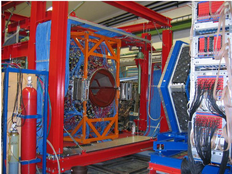
Abbildung 3.6: Foto: links im Bild ist der Crystal Ball Detektor mit Trärgestell zu sehen. Auf der rechten Seite erkennt man Teile des TAPS Detektors (Vetowand, einige  $BaF_2$ -Module und Teile der Auslese-Elektronik) [KPH08].
