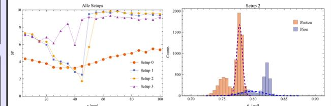
Beim Vertikalscan wurde parallel und in festem Abstand zu den ROMs durchgescannt. Der Rekonstruktionsalgorithmus versagt bei Abständen zum unteren Rand des Radiators von etwa 20 bis 55 mm. Photonen werden in diesem Bereich am Rand reflektiert und es tritt ein zweiter Cherenkov-Peak auf. Die fehlerhafte Rekonstruktion für Setup 2 bei einem Abstand von y = 45 mm ist rechts zu sehen, wo für Pionen der falsche Peak gefittet wurde.
