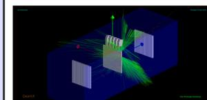
Zu sehen sind die Trajektorie eines Protons in blau und die beim Durchdringen der Quarzplatte emittierten Cherenkov-Photonen in grün. Die Photonen propagieren mittels Totalreflexion durch den Radiator und werden am oberen Ende von Readout-Modulen (ROMs) detektiert.
