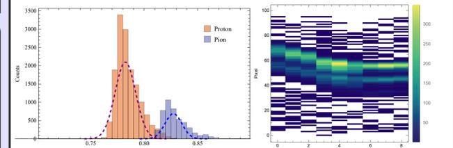
Gezeigt werden die rekonstruierten Cherenkov-Winkel und das Hitpattern für jeweils Protonen und Pionen, die mit einem Impuls von 3 GeV/c auf den Radiator treffen. Aus dem Hitpattern wird der Cherenkov-Winkel rekonstruiert und mittels einer Gaußfunktion gefittet.
