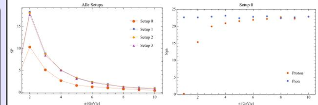
Die Anzahl der detektierten Photonen strebt mit steigendem Impuls gegen einen Grenzwert. Die SP und damit die Unterscheidbarkeit der Teilchen nimmt hingegen ab.
