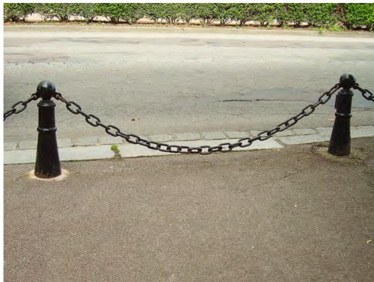
Abbildung 1.12: Ein an zwei Enden fixiertes durchhängendes Seil im Schwerfeld der Erde folgt dem Kosinus hyperbolicus (vgl. Abb. 1.13). Man spricht hier auch von einer Kettenlinie oder Katenoide. Bildquelle: Wikipedia
