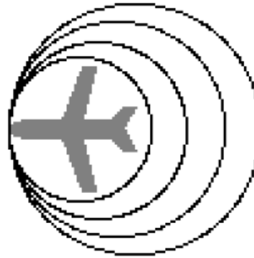
Flugzeug mit Schallgeschwindigkeit v = c
