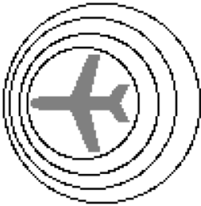
Flugzeug unter Schallgeschwindigkeit v < c Dopplereffekt
