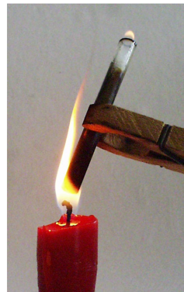
Abb.: 32 Ableiten brennbarer Dämpfe aus der Kerzenflamme (Foto H. Barth 2001)
