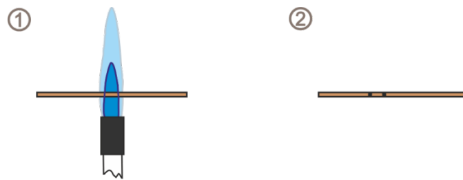
Abb.: 7 Untersuchen der Temperaturzonen
