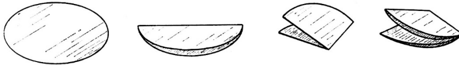
Abb.: 15 Falten eines Kegelfilters (Quelle: Meyendorf, Gerhard. Chemische Schulexperimente . Frankfurt/Main Verlag Harri Deutsch - Thun, 1983. Bde. Band 1 - Geräte, Chemikalien und Arbeitstechniken. ISBN 3-87144-485-5).
