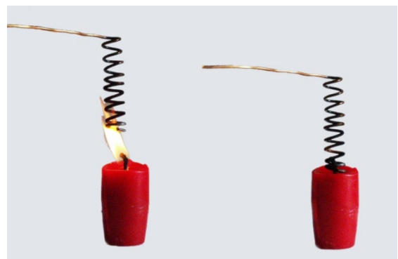
Abb.: 34 Wirkprinzip Flammenfalle (Foto H. Barth 2001)
