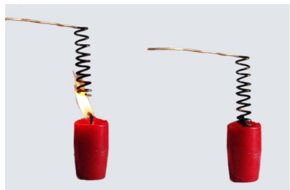
Abb.: 31 Wirkprinzip Flammenfalle (Foto H. Barth 2001)
