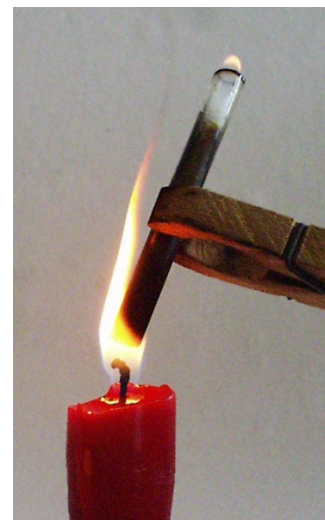
Abb.: 29 Ableiten brennbarer Dämpfe aus der Kerzenflamme (Foto H. Barth 2001)
