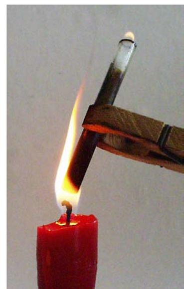
Abb.: 28: Ableiten brennbarer Dämpfe aus der Kerzenflamme (Foto H. Barth 2001)
