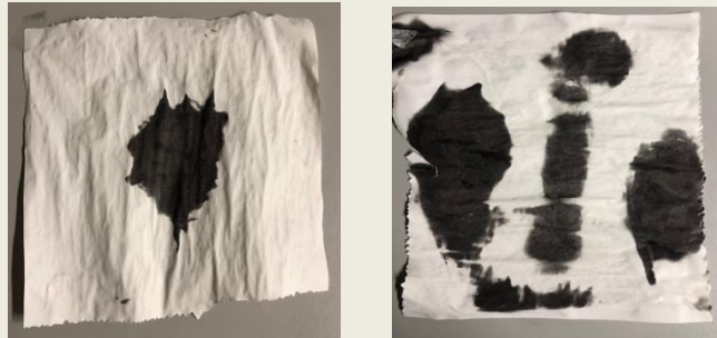
Bestimmung des hot spots verschiedener Mikrowellen mittels Thermopapier
