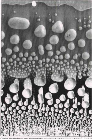
Genau hingeschaut: Das Rasterelektronenmikroskopbild von Eva Mutoro zeigt di Auflösung einer Silberschicht. Bild: priva
