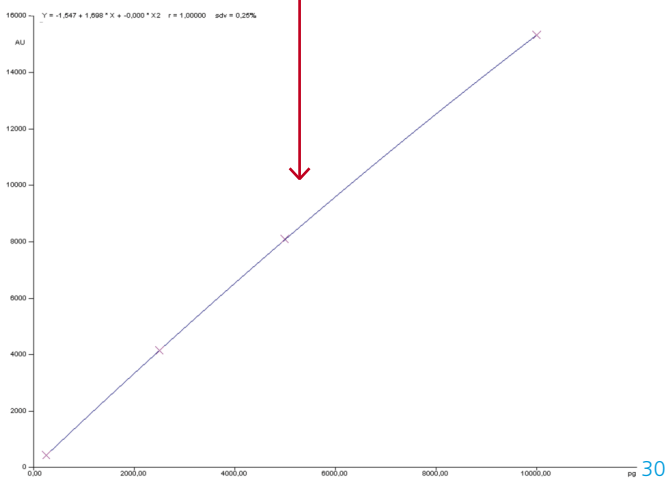
Kalibrierung von Benzo[a]pyren (0,25–10 ng/Zone), Fluoreszenz-Messung bei 366 nm/> 400 nm
