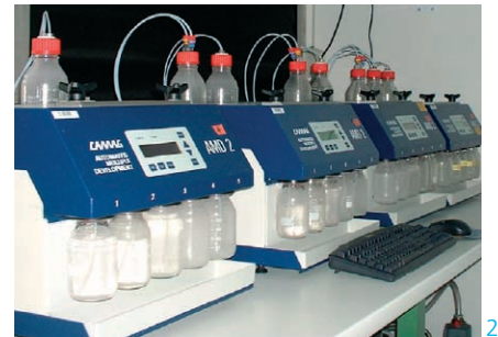
▲ Zur raschen Analyse von grossen Messreihen werden 4 AMD2-Systeme über eine serielle Schnittstelle mittels eines PC gesteuert.
