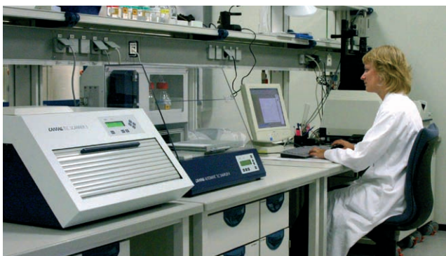
▲ Kerstin Armbrust am HPTLC-Arbeitsplatz bei der Quantifizierung von N,N-diethylethan-1,2-diamin in Metoclopramid-Fertigarzneimitteln
