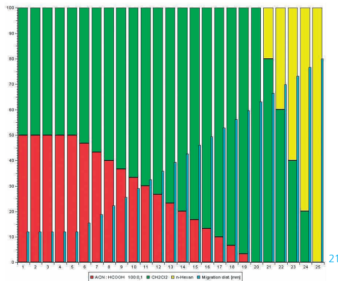
▲ 25-stufiger AMD2-Gradient, basierend auf Dichlormethan
