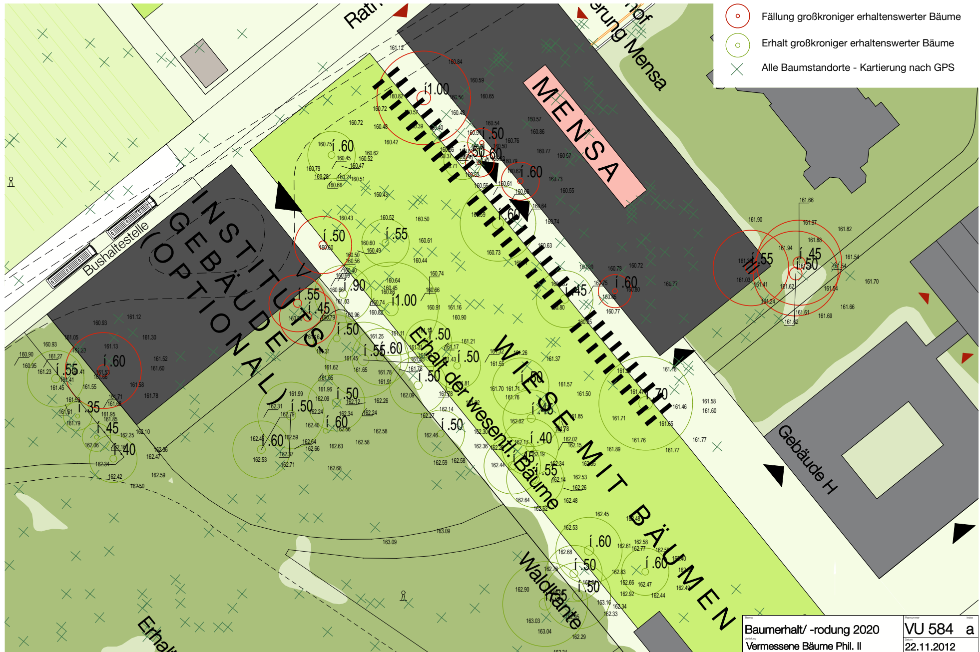
6.3 Freiraumplanung - Baumaufmaß / Überlagerung erhaltenswerte Bäume
