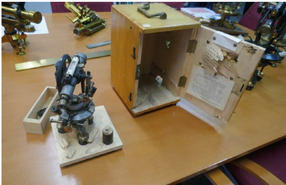
Bild 5: Reiss-Theodolit aus Liebenwerda mit beschädigtem Transportbehälter aus Holz (Foto: Bernhard Heckmann, Niedernhausen)
