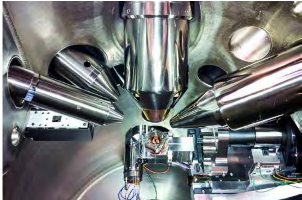
Blick in einen Röntgenphotoelektronenspektrometer des Laboratoriums für Materialforschung.
