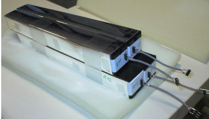
**Abbildung 3.6:** Vierergruppe von Kristallen mit Reflektormaterial und LAAPDs für den PROTO 60.
