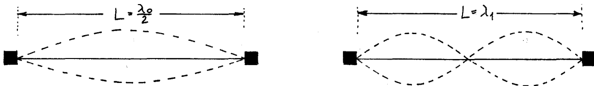
Abb. 3.18: Grund – und 1. Oberschwingung für einen beidseitig eingespannten Stab.
