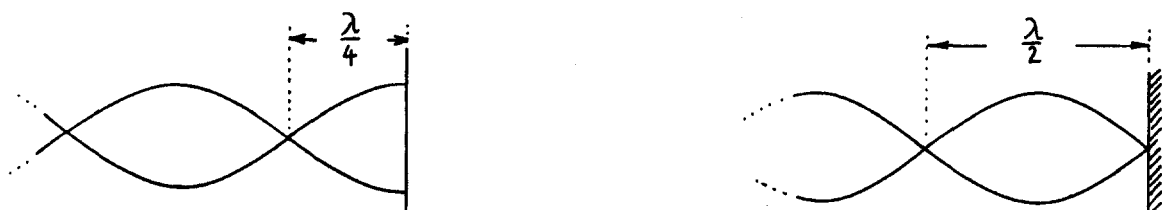
Abb. 3.16: Reflexion am dünneren (links) und dichteren (rechts) Medium.
