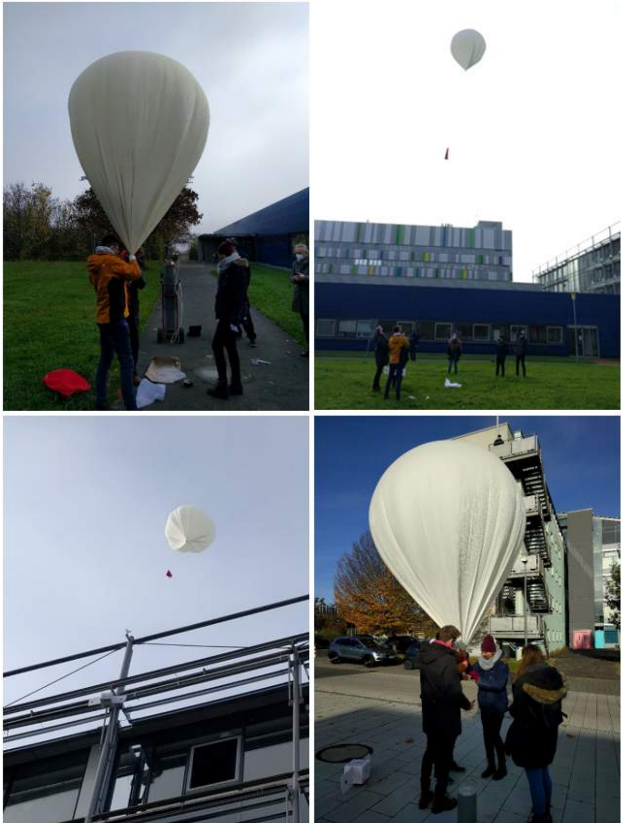
Abb. 6: Bilder vor dem Start: Befestigung der Sonde am Ballon (oben links), Ballon kurz vor dem ersten Start (oben rechts), Ballon am Unigebäude hängend (unten links) und letzte Vorbereitungen für den zweiten Start (unten rechts).
