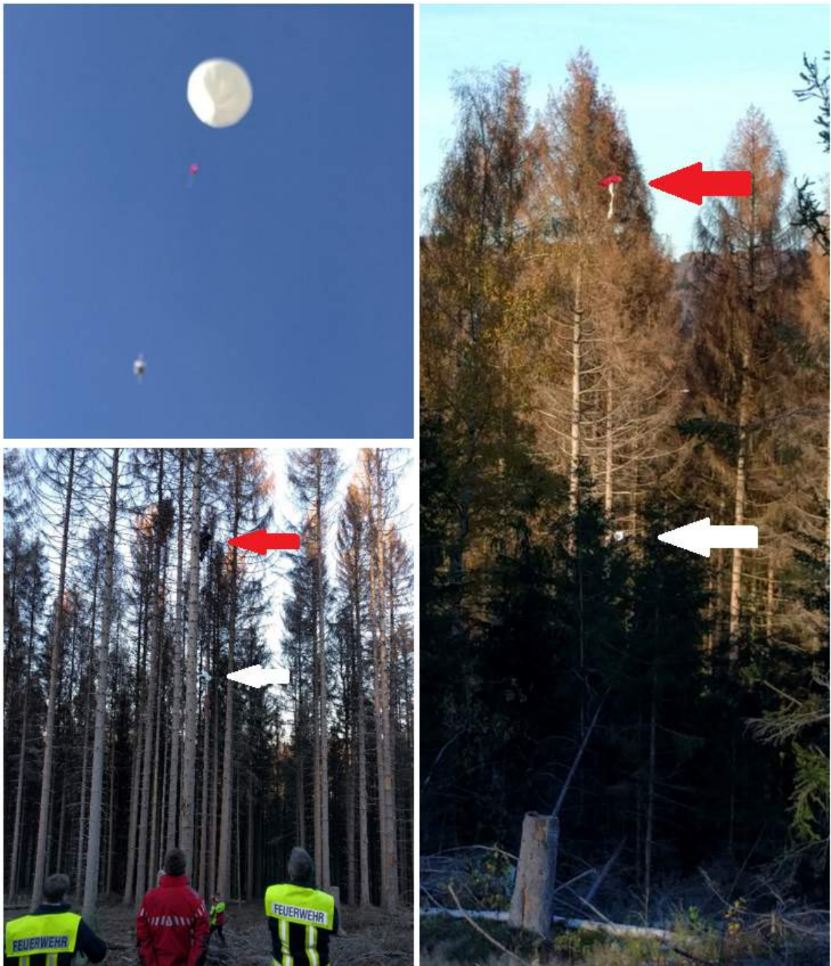
Abb. 7: Bilder nach dem Start: Ballon kurz nach dem Start in der Luft (oben links), im Baum hängend (rechts) mit Fallschirm (roter Pfeil) und Sonde (weißer Pfeil) und Bergung der Sonde (unten links) mit Baumkletterer (roter Pfeil) und Sonde (weißer Pfeil).
