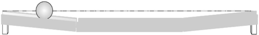
Wenn die eine Schräge weniger steil ist, wird die Kugel entsprechend weiter rollen, bis sie dieselbe Höhe erreicht hat.
