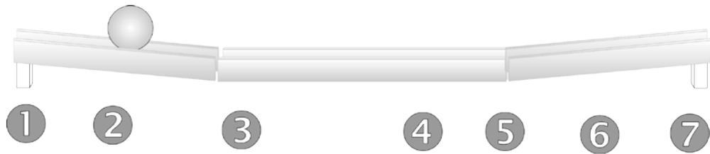
Bei dieser Aufgabe sollen die Schüler erkennen, dass die Geschwindigkeiten an den Punkten 1 und 7, 2 und 6 sowie 3,4 und 5 jeweils gleich sind. Dabei kann davon ausgegangen werden, dass sich die Punkte 2 und 6 auf gleicher Höhe befinden und die Reibung vernachlässigt werden kann (Erkenntnis aus Karte 2.12).
