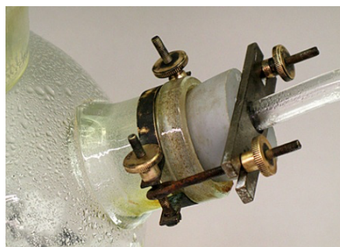
Abb.: 9 Sicherung eines am Gasauslass montierten Gasableitungsrohres (Foto: H. Barth; 2011)
