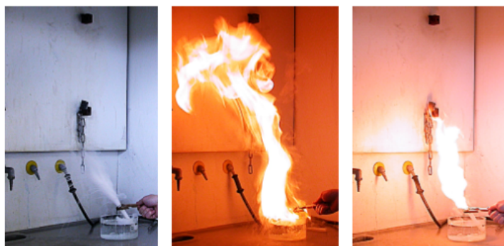
Abb.: 51 Selbstentzündung von Wachsämpfen (Fotos: H. Barth; 2011)
