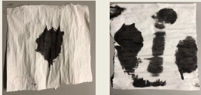
Abb.: 37 Bestimmung des hot spots verschiedener Mikrowellen mittels Thermopapier (Fotos: B. Romberg; 2018)
