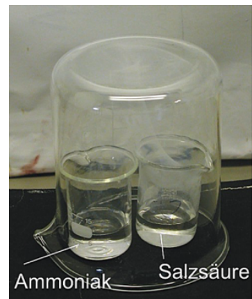
Abb.: 28 Ammoniumchloridbildung (Foto: H. Barth; 2011)
