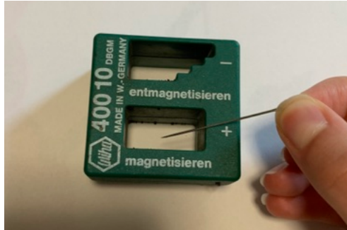
Abb. 13b - Entmagnetisierwerkzeug: Sarah Pappert
