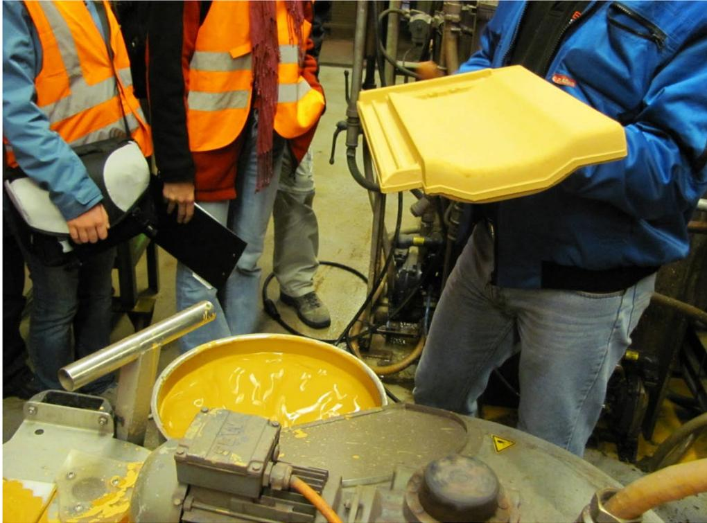
Durch das sogenannte Engobieren können Dachziegel mit ganz unterschiedlichen Farben (schwarz, blau, grün etc.) hergestellt werden. Hierbei wird der Rohling mit einem mineralischen Tonschlamm überzogen. Beim späteren Brennen versintern die Schlämme und ergeben eine matte bis mattglänzende Oberfläche in der gewünschten Farbe.
