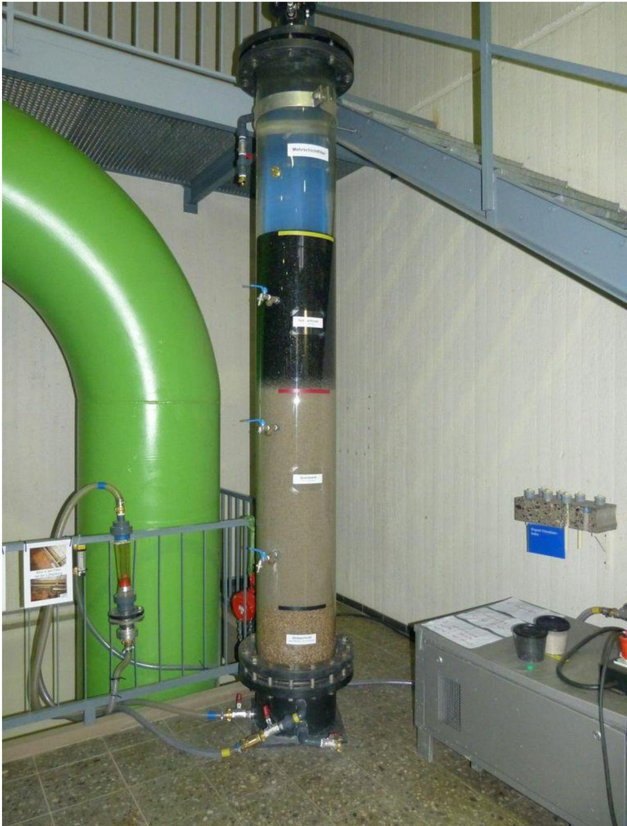
Ein Wasserfilter mit dem charakteristischen Lagenbau
