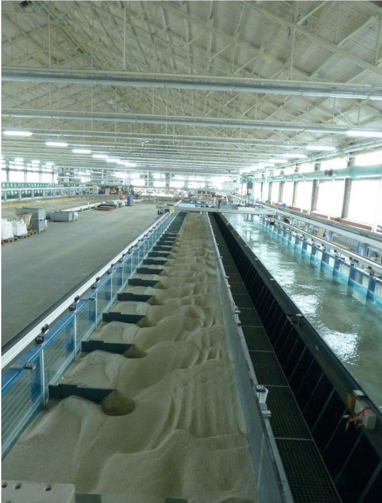
Eine weitere Halle der BAW mit einem Flussmodell, in dem u.a. die Bildung und Bewegungen von Dünen entlang der Gewässersohle untersucht werden können.
