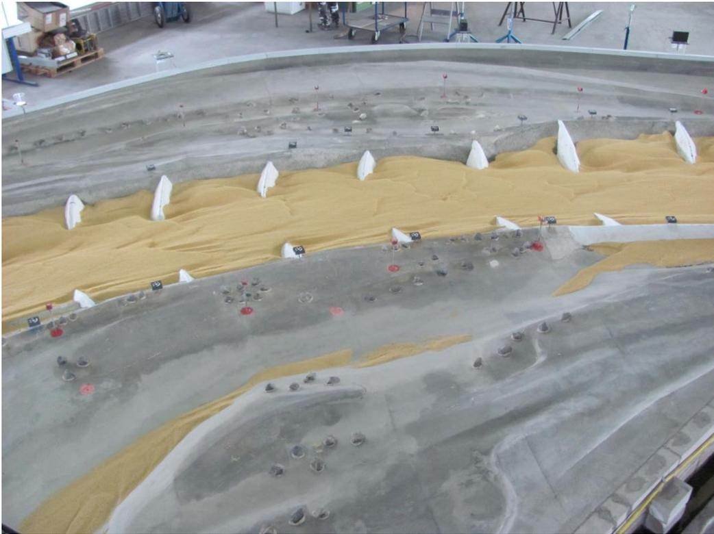
Detailaufnahmen zum Einfluss der Bühnenform auf die Unterwasser-Dünen.
