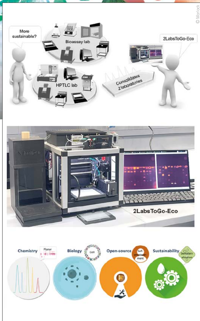
Abb. 3: Für jedermann einsetzbar ist das open-source 2LabsToGo-Eco, das selbst zusammengebaut werden kann (Materialpreis € 3.738) und für ein nachhaltiges und proaktives Schadstoff-Screening eingesetzt wurde [4].
