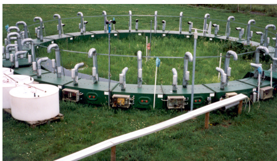
Gießener Freiland-CO 2 -Anreicherungssystem (Innen- \phi : 8 m)
