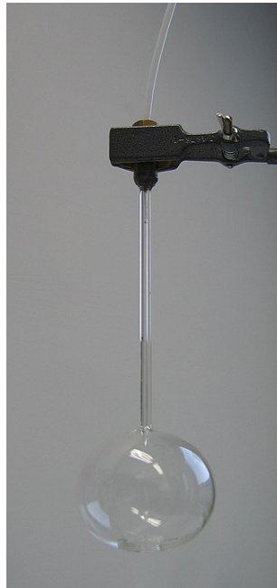
Abbildung 8.2: Gasthermometer. Der Schlauch führt zu einem Manometer zur Druckmessung.
