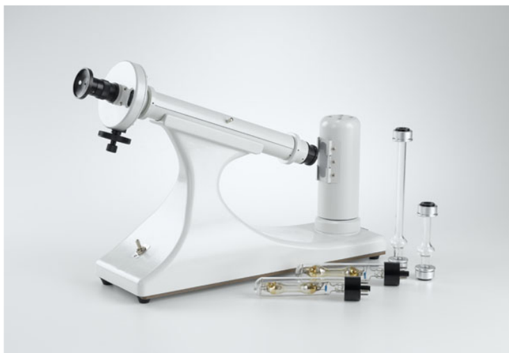
Abbildung 17.6: Polarimeter zur Messung der Zuckerkonzentration.
